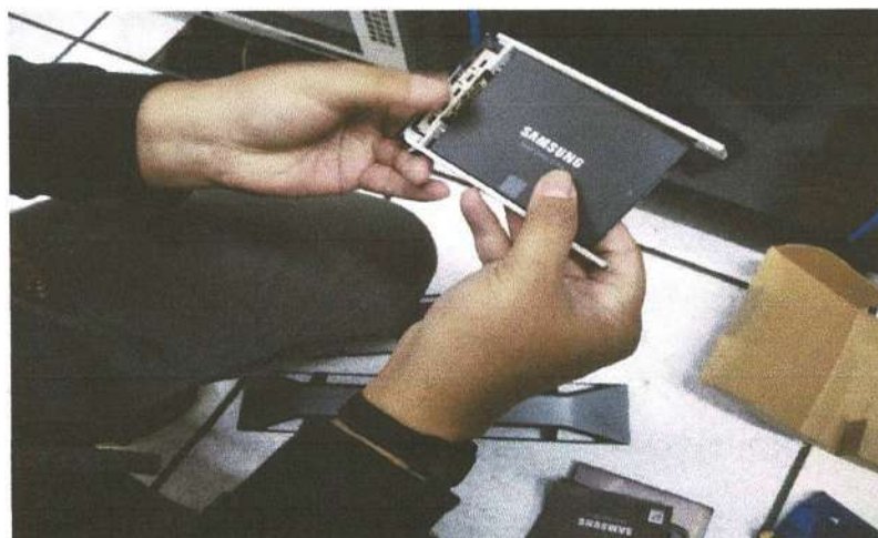
Gb. 3.21 Penggantian SSD di Data Center
